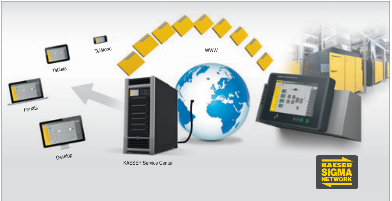
Figura 7: Las numerosas posibilidades de conexión de un controlador maestro contribuyen a un servicio más eficiente de la estación de compresores
