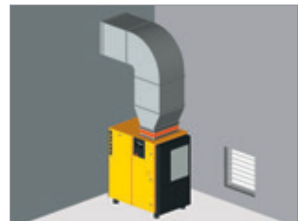
Figura 3: Ventilación artificial con ventilador externo: para unidades desde 11 kW
