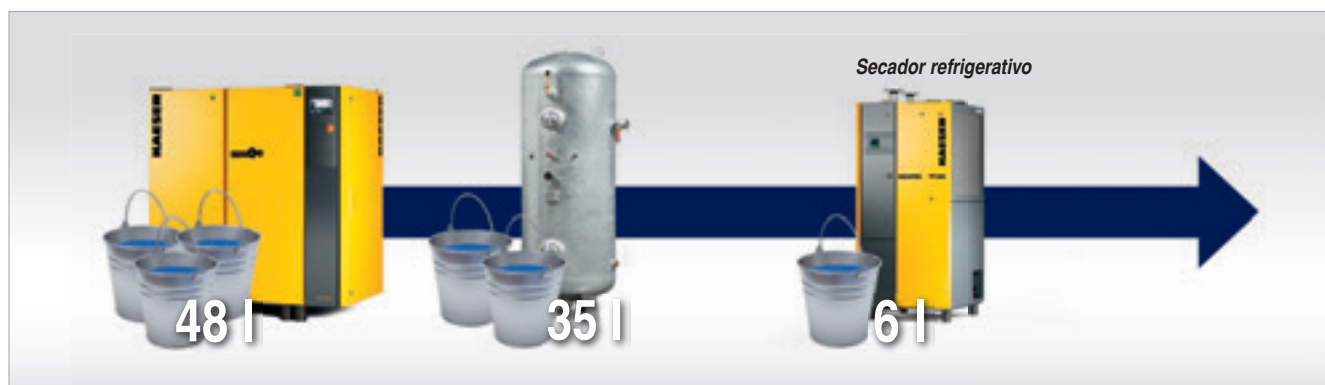
Figura 1: En la producción, almacenaje y tratamiento del aire comprimido se forma condensado (datos referidos a 10 m 3 /min, 10 bar abs , 8 h, 60% H rel y 20 °C)
