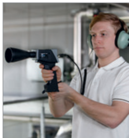
Figura 4: Localización de fugas por ultrasonidos
