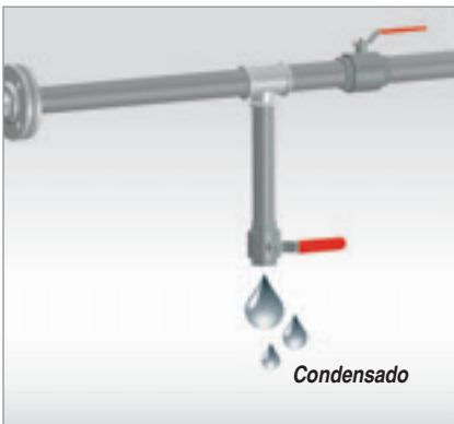
Figura 7: Comprobar si hay humedad en la tubería de salida
