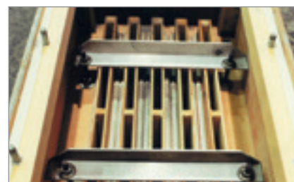
Figura 2b: Esterillas filtrantes (lado del compresor)
