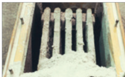
Figura 2a: Esterillas filtrantes (lado de aspiración)
